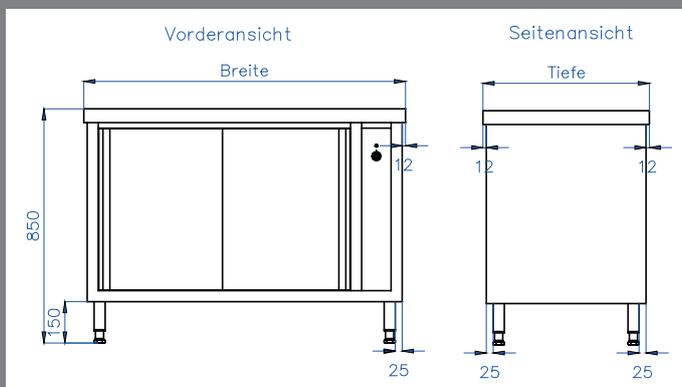
mit Schiebetüren, Unterbau doppelwandig und isoliert, verschweißt
