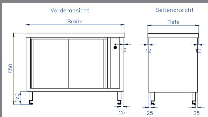
mit Schiebetüren, Unterbau doppelwandig und isoliert, verschweißt
